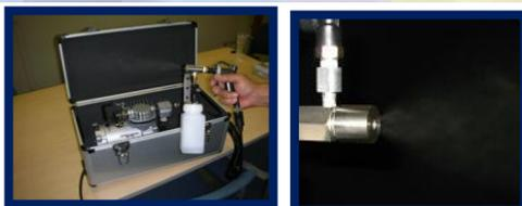
ミスト状で噴霧出来る特殊スプレーによる施工。ガラス面の風合いを損ねることなく、遮熱断熱・光触媒防汚コーティング施工が可能となりました。
